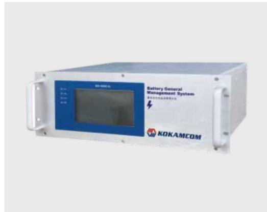
KKM-100I蓄电池在线监测管理系统是业内领先的在线电池监测产品,可针对传统阀控式密封铅酸蓄电池组运行中出现的单体电池过充电及欠充电现象进行在线均衡调节,使蓄电池组性能稳定运行保持最佳状态,提高蓄电池组安全运行水平;并能对性能落后的单体电池进行在线活化,可有效延长蓄电池组的使用寿命,降低电源系统维护时间和维护成本;同时在线检测单体电池电压、容量及内阻,给电源系统提供一个完整的预警系统,大大提高供电系统的可靠与安全。
